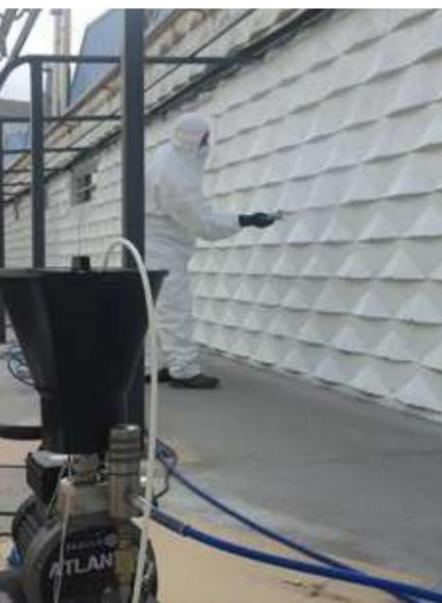
Pompa elettrica a membrana. Applicazione di trasparenti, fondi, smalti e vernici. In generale, prodotti a media viscosità.
