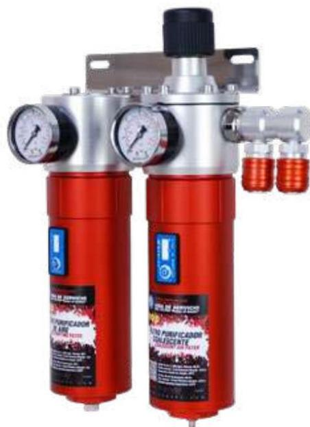
Il modello 5200X offre la più alta tecnologia per la filtrazione dell'aria. Incorpora un filtro in ottone sinterizzato da 8 micron, seguito da un filtro a coalescenza finale da 0,01 micron.
