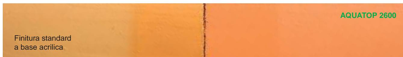
Confronto tra resistenza del rivestimento e l'effetto dei raggi UV. I campioni trattati con prodotto standard a base di acrilica e con il nostro nuovo prodotto di finitura AQUATOP 2600 sono stati esposti per 1000 ore nel misuratore QV. AQUATOP 2600 garantisce la migliore resistenza ai raggi UV - in tutte le tinte.
