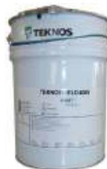
**APPLICAZIONE:** incolore a spruzzo, macchine applicazione, immersione o a flow coating e pennello 2 mani. Prima dell'utilizzo mescolare bene il prodotto. Essiccazione: maneggiabile: ca. 1-2 ore. Carteggiabile/riverniciabile: 2-3 ore. Pulizia degli attrezzi: con acqua. Resa: ca. 15 -25 m2/lt.
