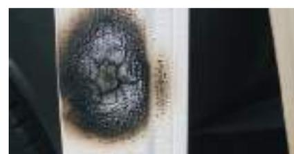
Test prova fuoco con pannello rivestito TEKNOSAFE 2407
